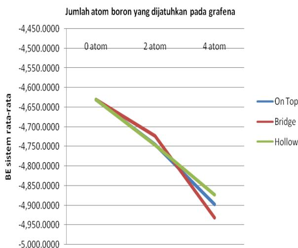
**Gambar 13.** Hubungan BE sistem rata-rata dengan variasi jumlah atom boron yang dijatuhkan pada grafena untuk tiap posisi
